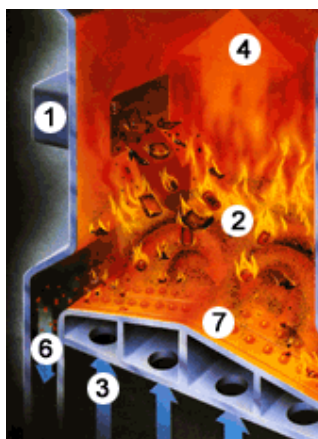
Rys. 8. Poglądowym schemat paleniska z wirującym złożem fluidalnym ROWITEC
