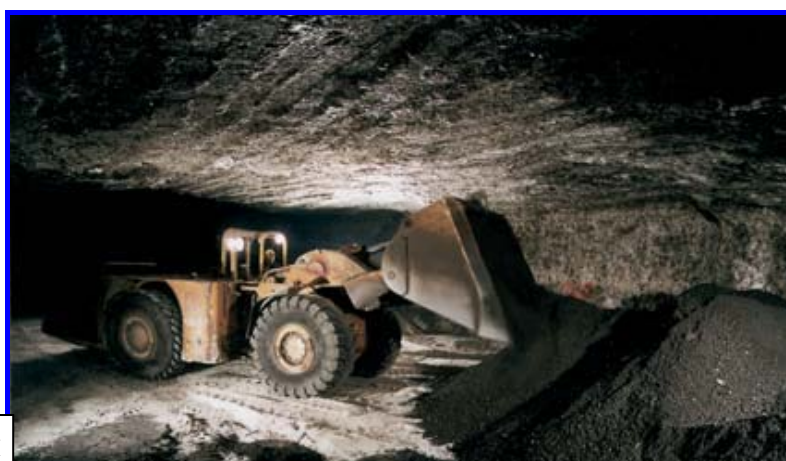
Rys. 10. Komora składowania popiołów lotnych i pyłów pochodzących ze spalarni odpadów komunalnych w jednej z kopalń soli w Niemczech
